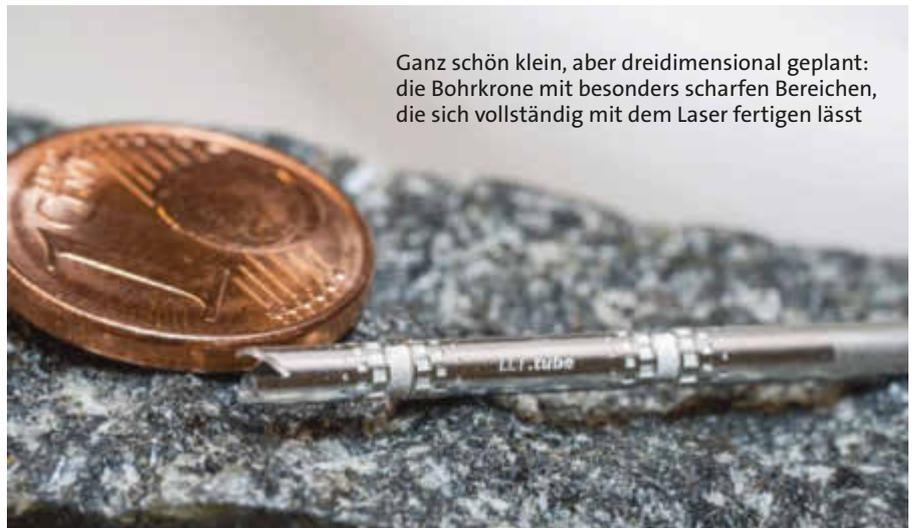
Ganz schön klein, aber dreidimensional geplant: die Bohrkronen mit besonders scharfen Bereichen, die sich vollständig mit dem Laser fertigen lässt
